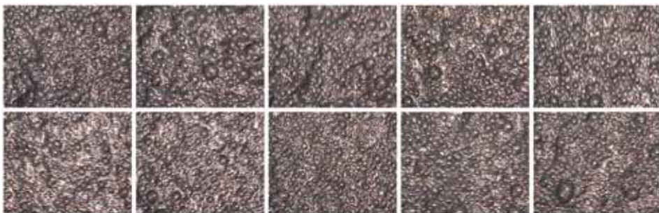
(d) See-through froth. Small transparent bubbles.
